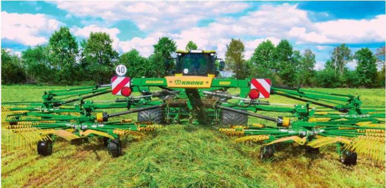
Da Krone bei seinem Schwader Swadro TC1370 einen hohen Volumendurchsatz ohne Abweichung in der Teilgenauigkeit erzielen wollte, nutzt das Unternehmen einen Stromteiler von Power-Hydraulik.
